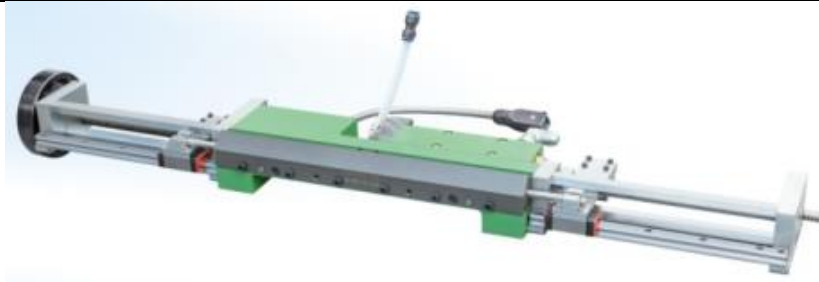
Щелевая головка шир.350 мм, с антипригарным покрытием.
